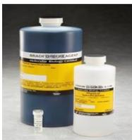
Das Bradford Protein Assay Kit wird für die Bestimmung der Total-Proteinkonzentration eingesetzt. Die Messung basiert auf der Komplexbildung von basischen und aromatischen Aminosäure-Resten mit der Coomassie-Blau-Färbelösung. Es können Proteinmengen zwischen 1 und 10  $\mu\text{g}$  bestimmt werden.
